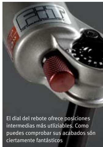
En la parte superior derecha encontramos el dial de bloqueo, compresión en baja velocidad y en color negro, el regulador de la dureza del propio bloqueo
